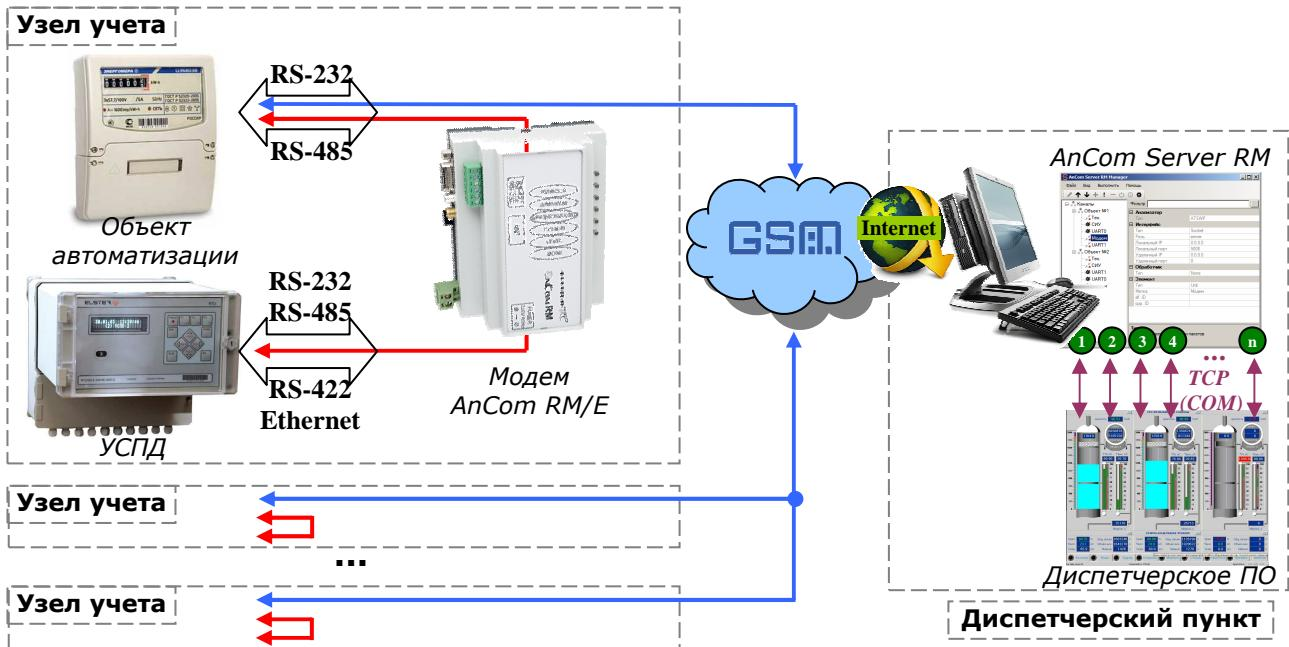
Локальный доступ УСПД к объекту автоматизации, подключенному к модему **AnCom RM/E** по интерфейсу RS-232 или RS-485, обеспечивается через дополнительный **последовательный интерфейс** модема (RS-232C, RS-485, Ethernet или RS 422).
